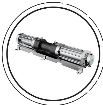
瀚孚工业HFHG1系列液驱气体增压器是以低压液压油作为驱动源，将介质气体增压至需求压力。液驱气体增压器标准设计最高工作压力为120MPa，针对更高工作压力，可提供特殊设计。液驱气体增压器高效的服务于气体超高压大流量工况。
